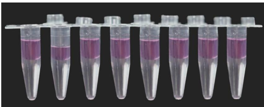
注 1：最后形成的混合液（如上图所示）包括 Demulsion Agent/Carrier Oil（透明）和水相反应液（粉红）。
